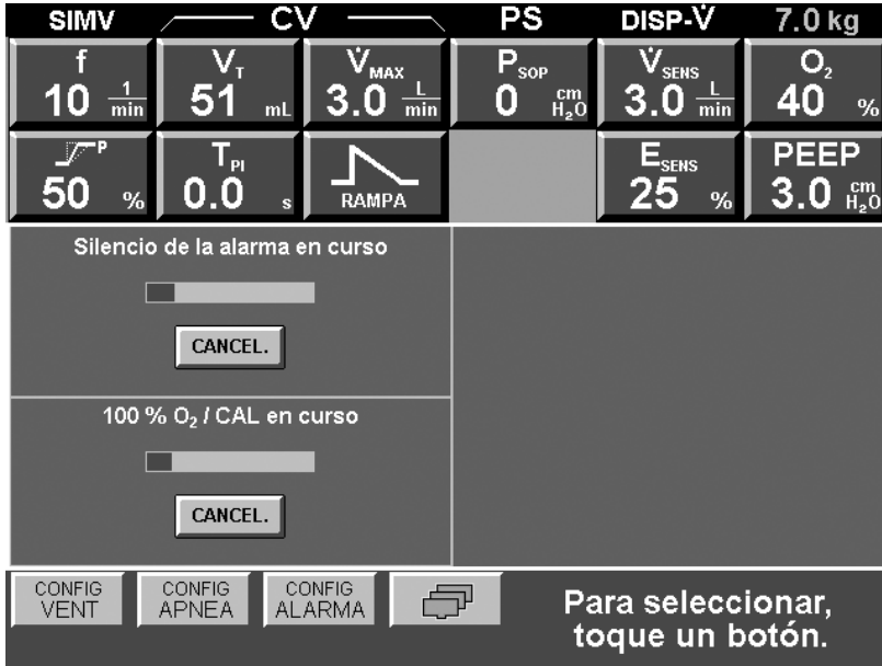
Figura 5-2. Indicador Silenciador de alarma en curso (pantalla inferior)
