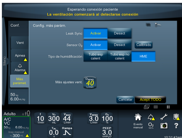
Figura B-1. Habilitar Leak Sync
