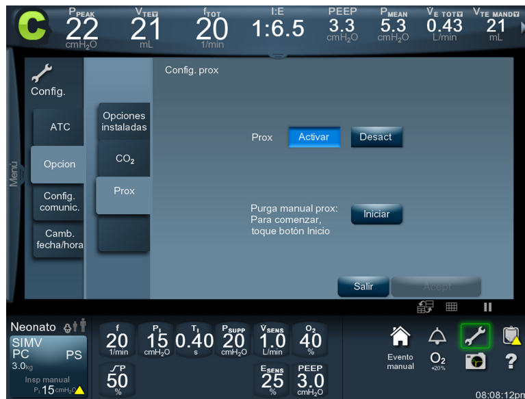
Figura E-5. Habilitar/deshabilitar el sensor de flujo proximal
