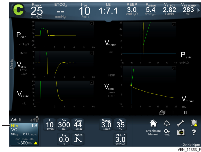
Figura 4-9. „NIV” pe butonul Configurare vent., indicând tipul de ventilație NIV
