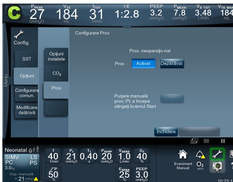
Figura E-5. Activarea/dezactivarea senzorului de debit proximal
